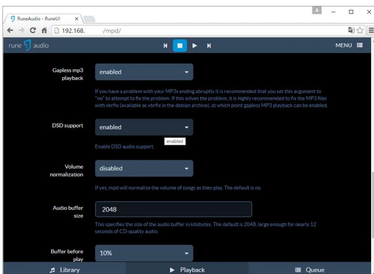
MPD CONFIGURATIONにてDSD supportをenableにする。
